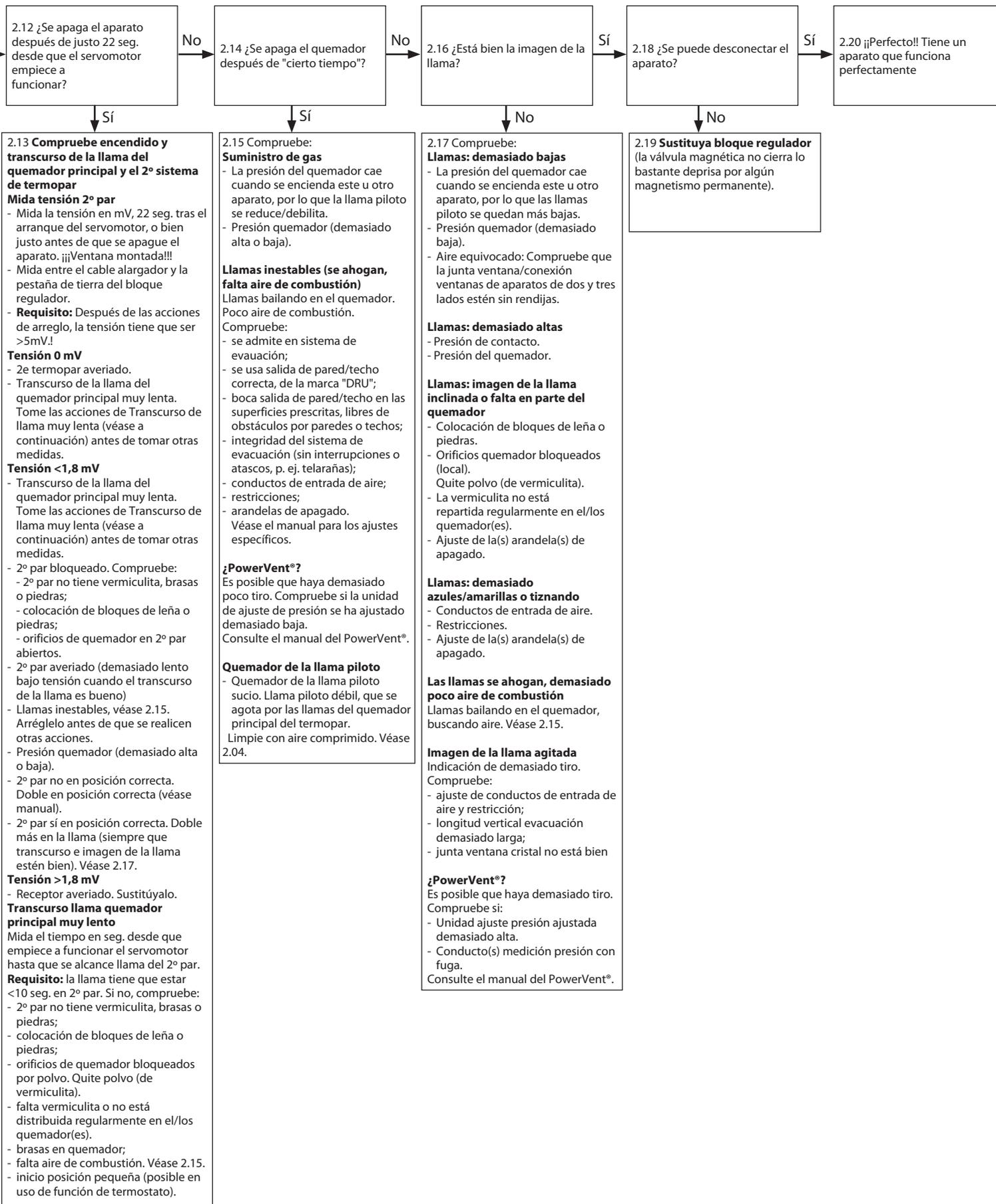
Resolución de averías de estufas atmosféricas de gas con encendido electrónico: ciclo de puesta en marcha (Mertik GV 60)
